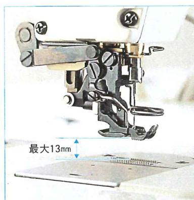
押え上昇量は13mmと高く、上送り機構の内装化で押え回りがスッキリし、素材のセットや振り回しが容易です。縫目調節ダイヤルは大きくて使いやすく、設定値の変更が容易。オペレーターの意のままに軽快操作できるミシンです。
