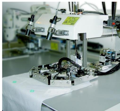
また、押さえパットの上下動は、厚みのある素材にも応じられるよう、針元では 10 mm、折り込み装置から素材をピックアップする際は 15 mm と、二段階の動作がきめ細かくプログラムされています。シャツの薄物素材では、ポケット口の両端ではみだしを防ぐ、コーナーの三角同時折り込みも行っています。
