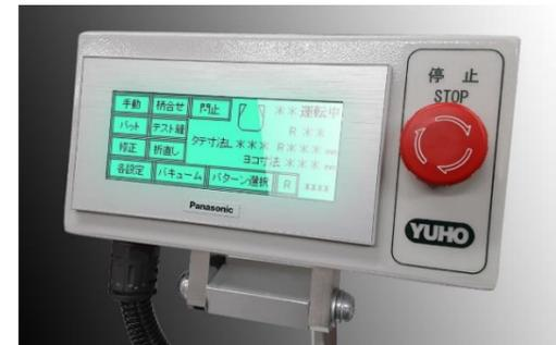
液晶タッチパネルで、各装置のチェックや調整等が簡単に行えます。例えば、個々のポケット形状に従って作成される縫いパターンデータは、30 パターンまで本体に記憶でき、更に個々のパターン毎に、必要に応じて、ユーザーが部分修正の修正値を入力することで、シームマージンを完璧に追いつくことが可能。縫いパターンの部分修正は、タッチパネル上で「修正」を選ぶことで、即、微量なステッチ位置の修正値が入力可能となります。更に、パターンの部分部分で送り速度の加減を設定し、ベストな縫い線の形状を実現できます。ステッチの片寄りの修正、ステッチ幅の拡大・縮小も、タッチパネルの操作で簡単に行えます。ポケット布の折り込みの際、万一、確実に折り込まれていなかった場合は、「折直し」を押すだけでワンタッチで折り込みをやり直すことが可能です。
