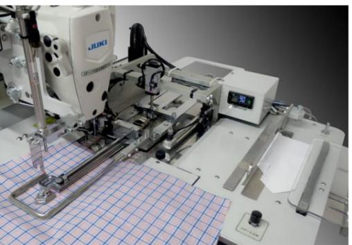
XY 駆動軸には、高精度と高剛性を誇るリニアウエイの採用により、超精密な動作と高耐久性を高い次元で両立しています。また XY 軸の送り動作には、パワフルなパルスモーターを採
