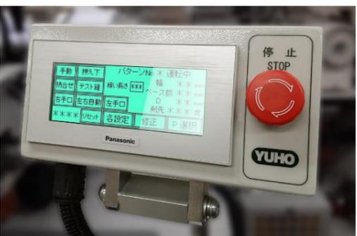
運転時の右手口、左手口の切り替えや左右交互自動切換え運転、あるいは縫いパターンデータの選択といった操作が、液晶タッチパネルに触れるだけで簡単に済みます。縫いパターンデータは 10 パターンまで記憶でき、呼び出しもワンタッチ。
