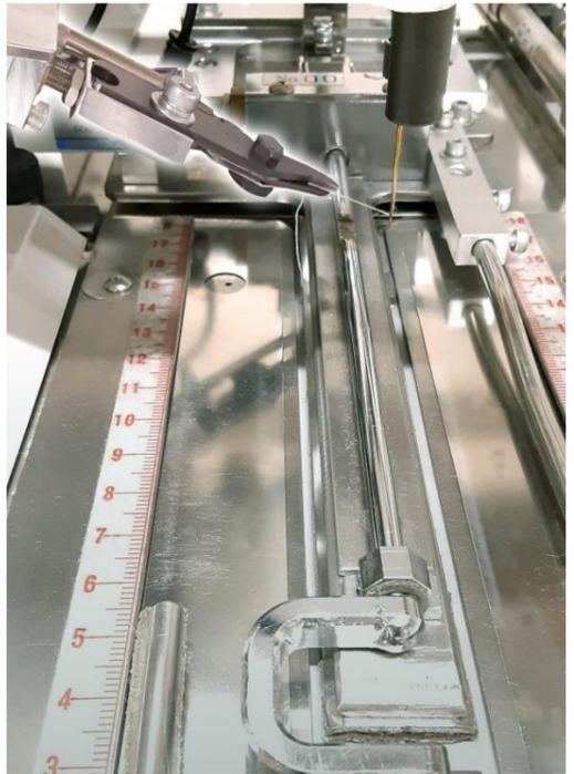
針元に装備された糸つかみ装置が針糸を糸切りと同時に保持することで、縫い始めの糸抜けや上糸による鳥の巣の発生を無くし、きれいな縫い出しを実現します。
