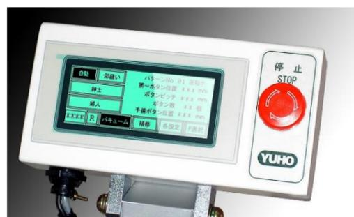
第一ボタンまでの寸法、ボタン間隔、予備ボタンまでの間隔、予備ボタンの有無、ボタンの数、下糸カウンター、パターン No.などが同一画面に表示され、パラメーター選択や数値入力は画面タッチで簡単に行えます。
