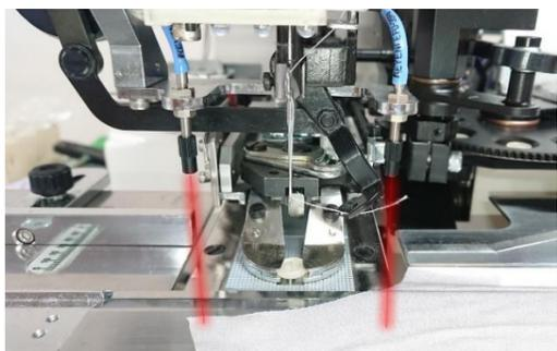
紳士用、婦人用の 2 個の光電センサーが、素材端を自動検知し、第一ボタンの位置からボタンの間隔、ボタンの穴数を高精度に割り出し、ボタン付けを行います。
