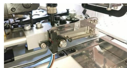
運転中にボタンキャリアでボタンの供給ミスが生じた場合、ボタンつまみ足装置でのボタン有無を検知し、自動で運転を一旦停止します。その場合、ボタンフィーダーで改めてボタンを供給し、スタートペダルで残りの動作を再スタートさせ、スタッカーで積み重ねまで行うため、ロスタイムを最小限にとどめることができます。
