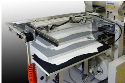
素材自動供給装置の積載リフト部は、長さ750mm x 幅300mmの素材を、最大180mmの高さまで積み上げて装填することが可能。機械が絶えず積み上がった素材の山の最上部の位置を検知し、積載数量が減っていくにつれリフトが自動で上昇、常に素材の最上部が同じ高さに保たれます。
