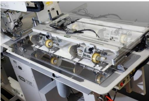
素材を掴む、離すを1枚1枚確実にを行うために、粘着テープ方式を採用、計4本のテープで確実に素材をピックアップします。1回のピックアップ動作毎に、新しい粘着面を0.2mm自動的に繰り出し、使用しては巻き取るを繰り返すことで、常に安定したピックアップが行えます。素材のピックアップ位置やリリース位置は、液晶画面上で正確かつ簡単に設定が可能です。
