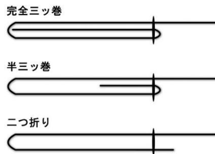
素材は本機の作業テーブルに搭載された強力なバキューム装置で保持されつつ、三ッ折り装置により確実に三ッ巻され、直後にガイドレールで確実に押さえながら針元に搬送し、即ステッチ縫いが行われます。
