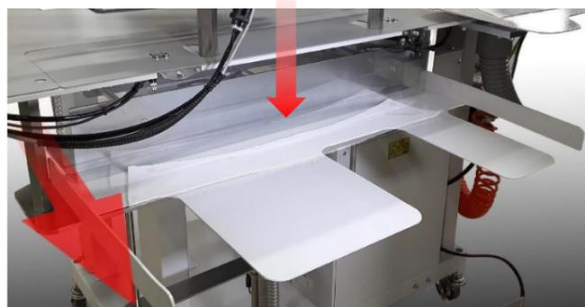
縫い工程後、素材は落とし込み式のスタッカー装置により、きれいに揃えて自動積み重ねが行われます。積み上がった素材が、予め設定した枚数に到達すると、自動的にイジェクトされる機構により、取り出しもラクラク行え、次の工程への搬送もスムーズです。
