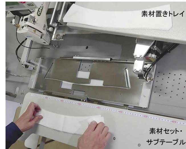
また本機は、衿地縫い用途に必要な十分な、タテ 85mm x ヨコ 550mmの縫製エリアを確保しています。
