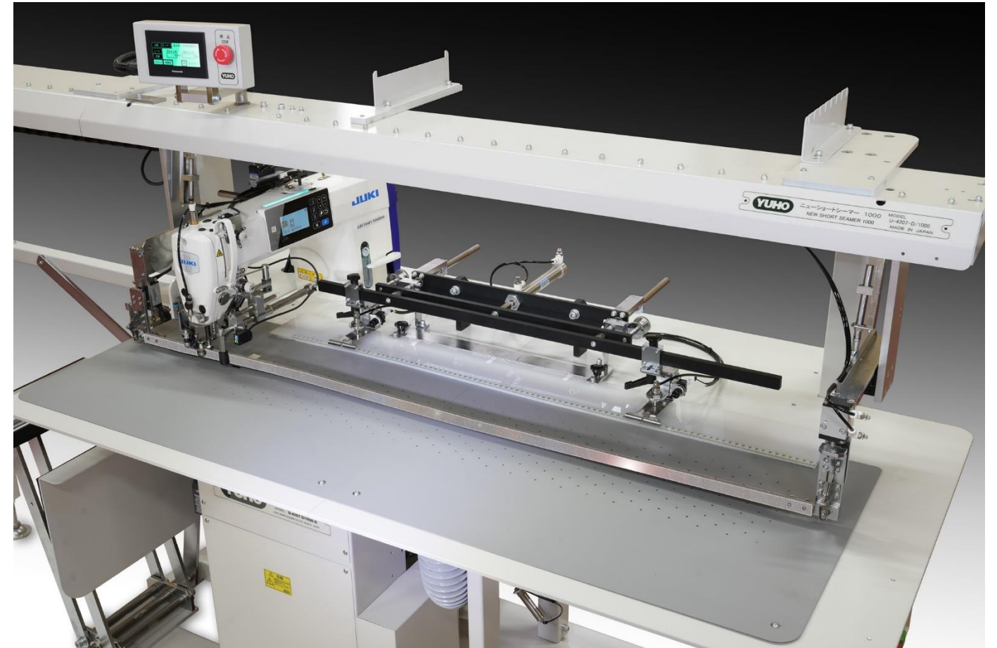
直線ガイドレールと直線定規(標準付属品)
