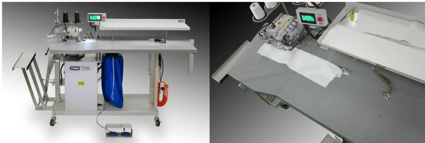
**上イセ込み、下イセ込みにそれぞれ専用のステッピングモーターを採用した、究極のイセ込み自動機**
