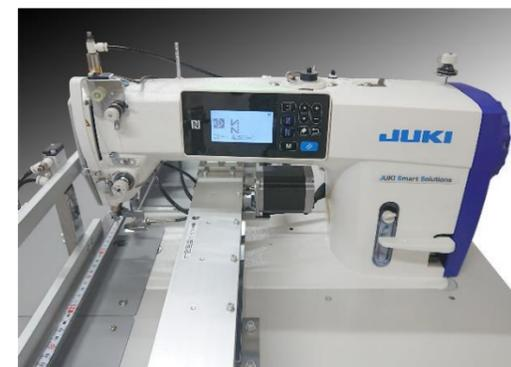
ミシン頭部は最新型の JUKI DDL-9000C ダイレクトドライブミシンを搭載。立ち上がり速度の速さや停止精度の高さ等、ミシン自体の基本性能である応答性・追従性に大変優れています。
