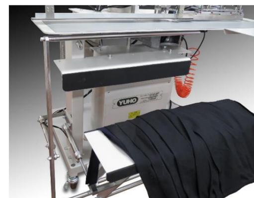
新型サバキ付きスタッカー装置により、縫われた素材は確実に美しく揃えられ、自動で積み重ねが行われます。スタッカー動作時、オペレーターは次の素材のヒダ折り込み作業をオーバーラップして行うことが出来、素材の取り置きタイムが改善され、高能率な作業を実現します。
