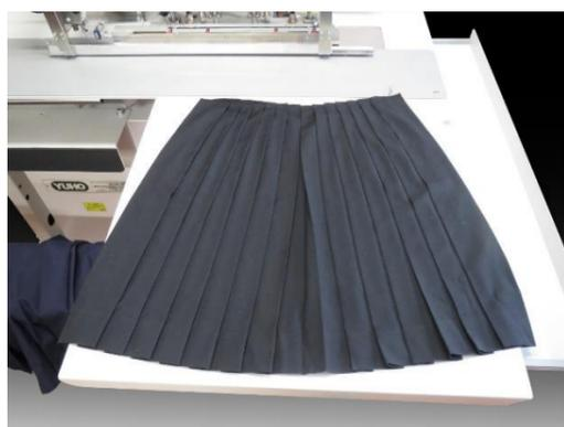
ウエストサイズをヒダ数で割った 1 ヒダ間隔を確実に折り込み、正確なウエストサイズとヒダを仮止め縫いします。このヒダ折り込み操作はオペレーターの熟練度に合わせ、1ペダル:1ヒダ操作、2ペダル:ヒダ+影ヒダ操作、自動連続操作 を、自由に選択して使用でき
